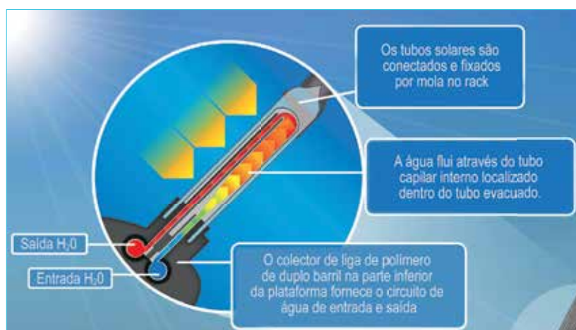
Figura 3. Os tubos absorvem a radiação solar e transformam-na em água quente, independentemente da temperatura ambiente. Tubos, quadro e sistema do coletor são projetados especificamente para uso em piscinas e spas, e oferecem uma vida longa, mesmo em ambiente hostil.
