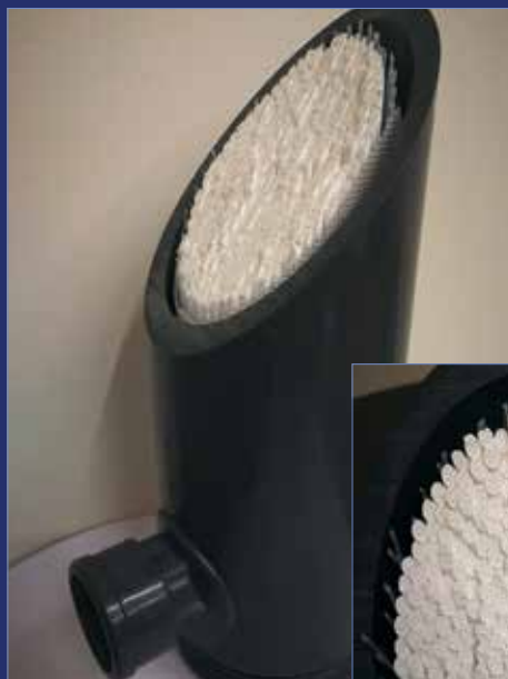
Figura 1. Secção de um módulo de ultrafiltração. O corpo de PVC contém cerca de 600 "palhinhas" e cada uma tem sete fibras ocas com o diâmetro de 100 µm. No fundo, cada módulo tem 60 m 2 de área de ultrafiltração.
